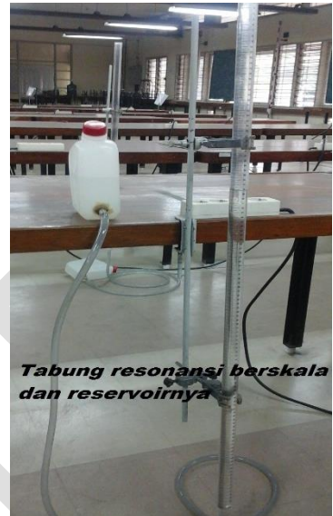
Gambar 10.2. Komponen-komponen eksperimen resonansi gelombang bunyi.
